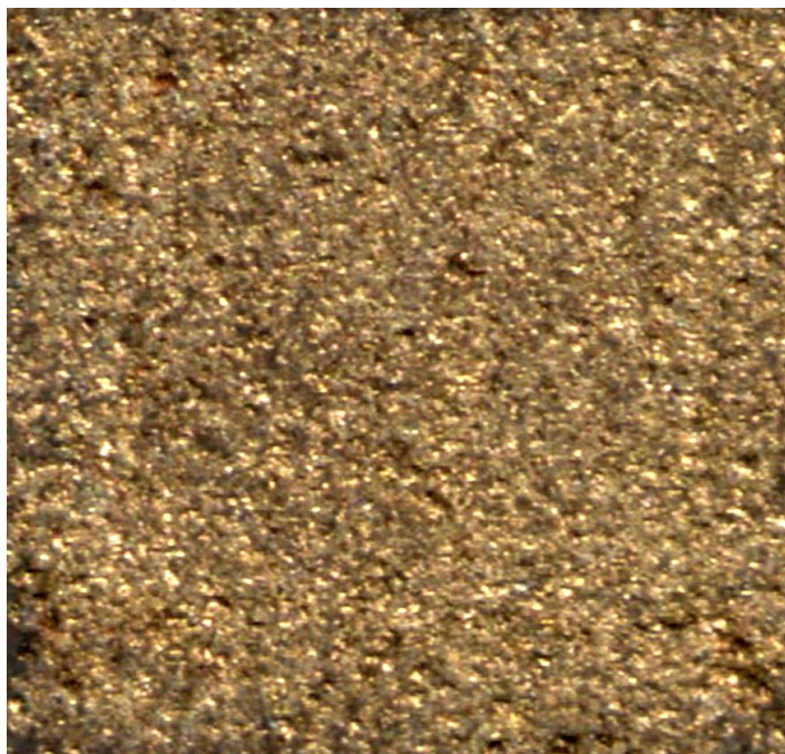
Fig.5.18. Strat obținut prin metoda depunerii pulberilor metalice cu aplicarea descărcărilor în impuls cu rupere de contact (Catod – otel-45; Anod – BrOȚS-5-5-5. Pulberi metalice BrA-7.
