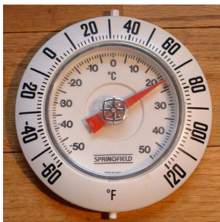
Fig. 8. Termometru cu unități Fahrenheit pe scara exterioară și unități Celsius pe scara interioară [7]
