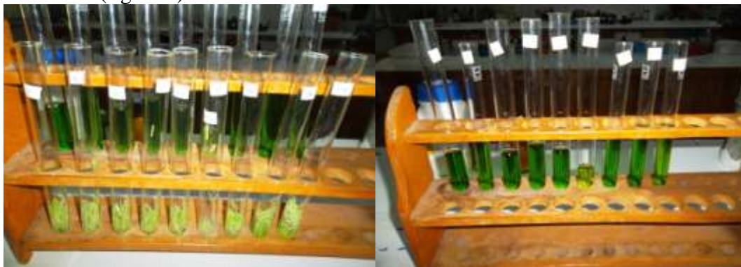
Fig. 4. Extracția aminoacizilor cu alcool etilic 80%
