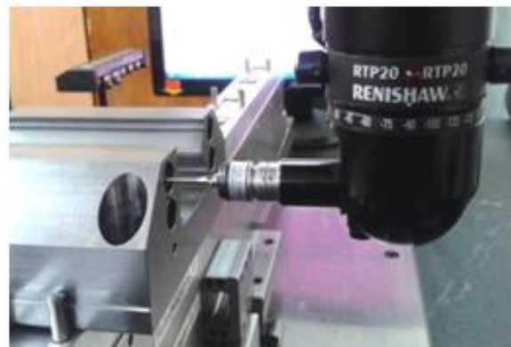
Fig. 4. Vermessung der Genauigkeit der Durchmesser der Rücklaufbohrungen eines Rollwagens mit Koordinatenmessmaschine Aberlink [5]
