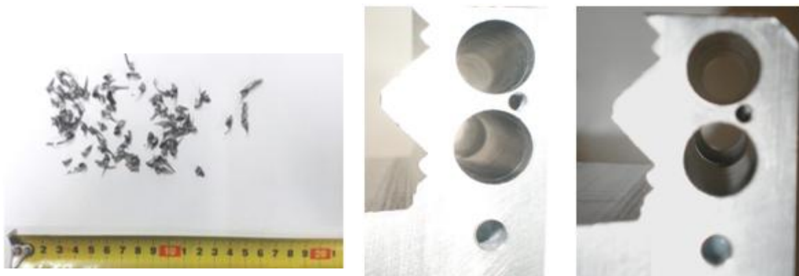
Fig. 6. Form und Abmaßen von abgeschnittenen Spänen beim Bohren von Rücklaufbohrungen mit dem Bohrer \phi 11.03 H7 der Firma MK-Tools
