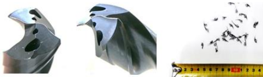
Fig. 10. Gleichmäßiger Schneidenschleiß und minimale Abmaßen der Späne beim Bohren mit dem Werkzeug \phi 11.03H7 der Firma Sau und bei v_c = 66 m/min und f_z = 0.072 mm/Zahn
