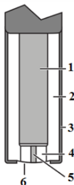
Fig. 5. Părțile componente ale electrodului de oxigen dizolvat: 1 – anod din Ag , 2 – soluție de electrolit ( KCl_{(aq)} ), 3 – carcasa sondei, 4 – izolatorul catodului, 5 – catod din Pt , 6 – membrană
