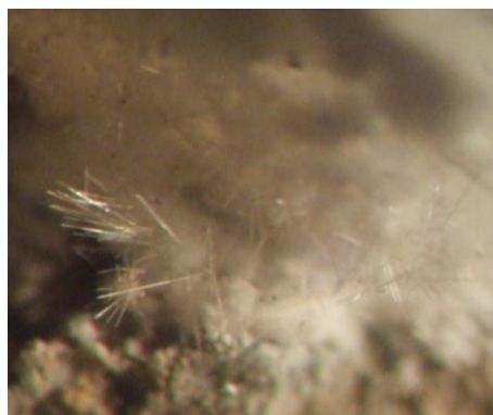
Fig. 3. Microstructuri de oxid de zinc aciforme formate pe frontiera craterului prin acțiune cu radiație laser IR.
