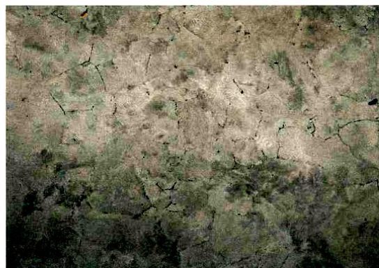
Рис. 4. Цементит по границам перлитных зерен в катанке из стали марки С82D.
