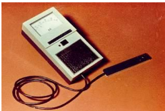
Fig. 4. Dispozitiv cu scală logaritmică pentru măsurarea intensității în limitele valorilor 10^{-4} - 10 mW/cm^2 ; domeniul lungimilor de undă 280-400 nm. Alimentarea- 4.5 V.
