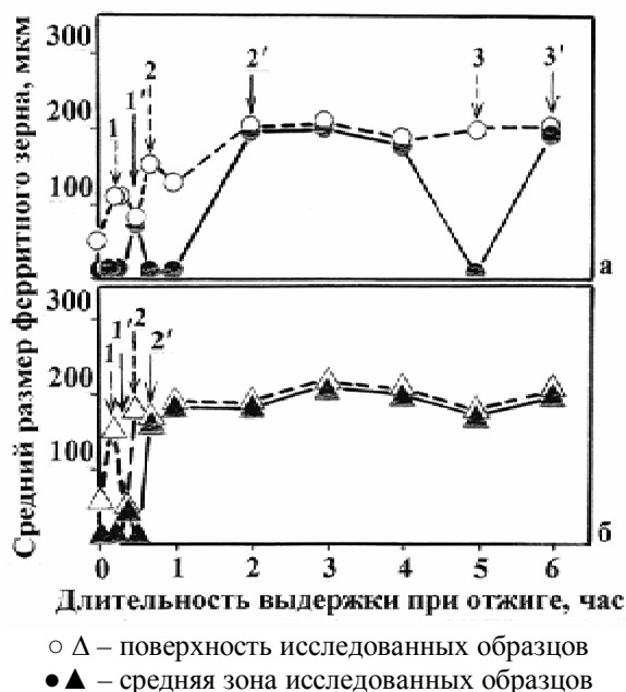
Рис. 2. Изменение среднего диаметра зерен феррита в зависимости от длительности выдержки при отжиге. T_{КП} = 700 (а) и 750 °С (б). Цифрами без штрихов и со штрихами обозначены длительности выдержек, при которых формируются разнотерные и равномерные структуры феррита соответственно
